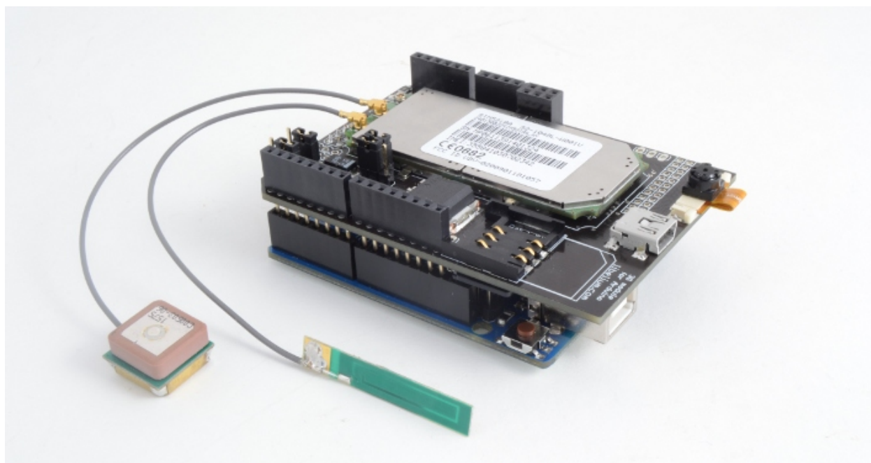
Figura 2.3: Placa Arduino Uno connectada amb placa 3G/GPRS.
