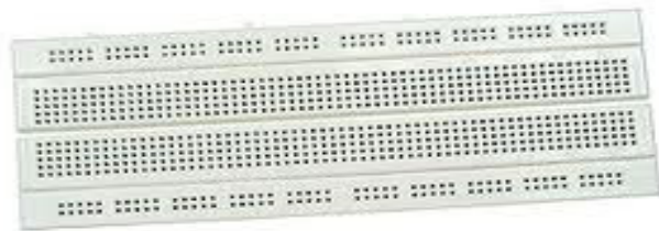
Figura 7 - Taula de proves sense soldar 'Protoboard'
