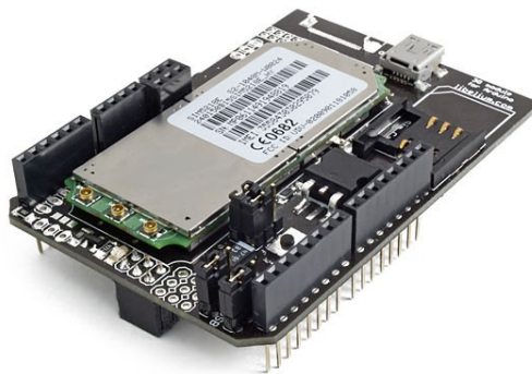
Figura 10 - Mòdul 3G/GPRS compatible amb Arduino i Raspberry pi
