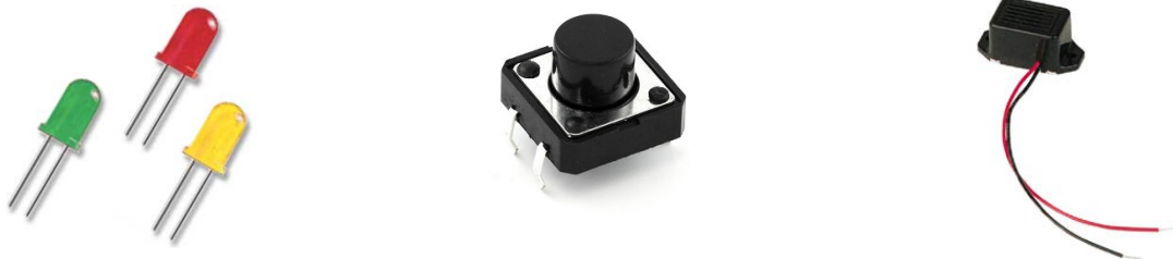
Figura 8: Leds, botón, zumbador
