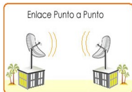
Ilustración 11: Conexión punto a punto
