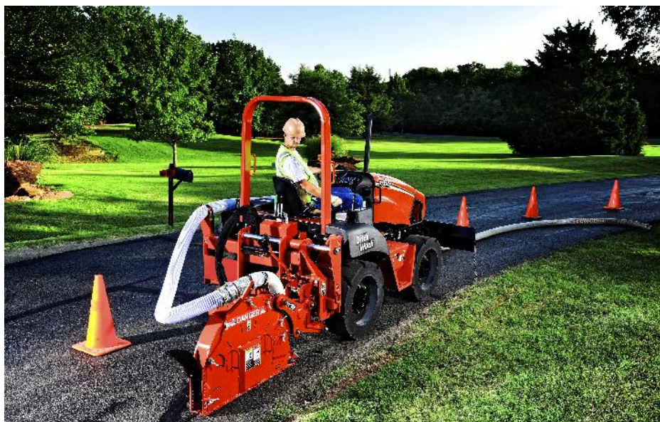
Imatge 21: Imatge d'una màquina de fer micro-rases en acció: Font: http://www.ifema.es
