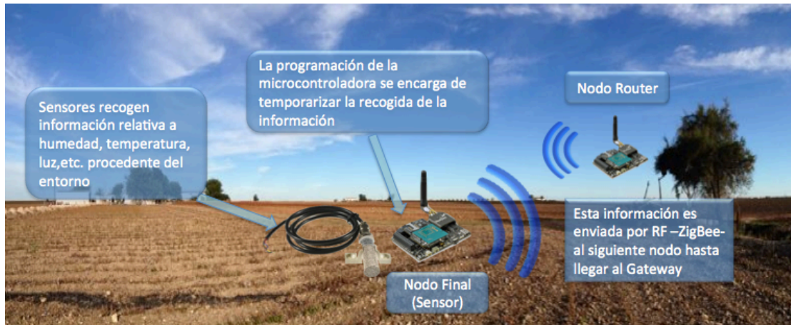
Figura 29 Esquema simplificado comunicación WSN
