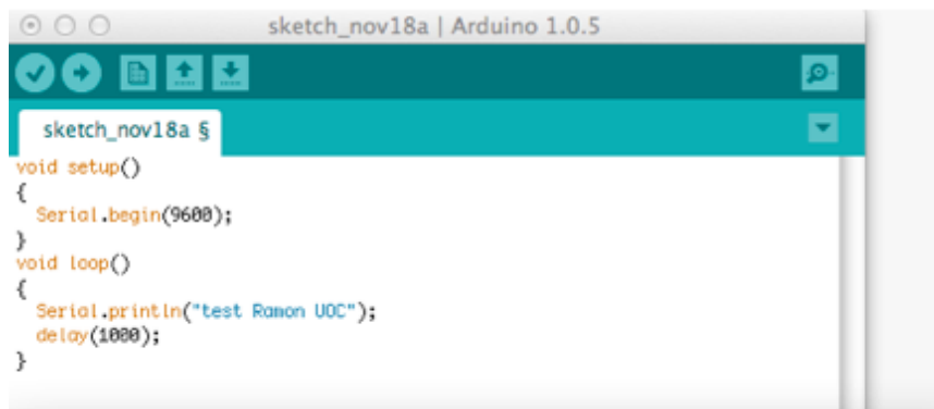
Figura 44 Sketch configurado en nodo Final para enviar mensaje por Radio
