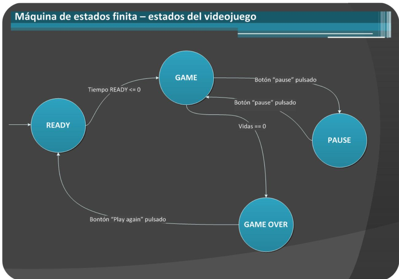
**ilustración 8. Máquina de estados del videojuego**
