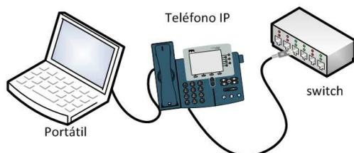
Otra configuración posible sería configurar un trunk en el puerto de acceso permitiendo el paso de las vlan de datos y voz con su correspondiente etiquetado como bien hemos explicado antes. Una de los puntos a tener en cuenta es que el tráfico del ordenador vendrá sin etiquetar. Para este tráfico utilizaremos la vlan nativa. De modo que si a un puerto llega una trama sin etiquetar, la trama se considerara perteneciente a la VLAN nativa de ese puerto.
