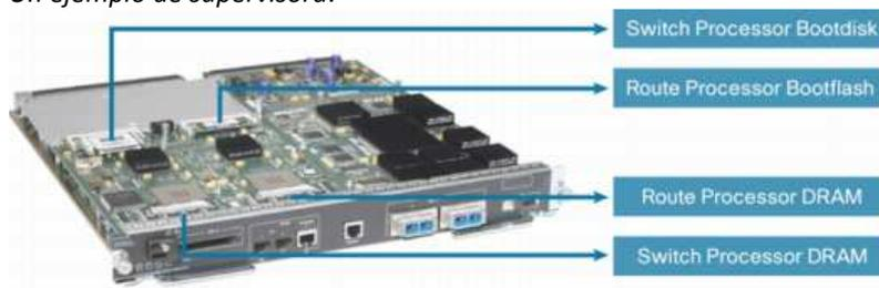
En resumen el SP = procesador switch processor y el RP = procesador de routing.
