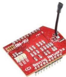
Figura 4: Mòdul WiFly RN-XV de Roving Networks
