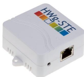
Figura 18: HWg-STE. Termòmetre Ethernet amb alertes per e-mail
