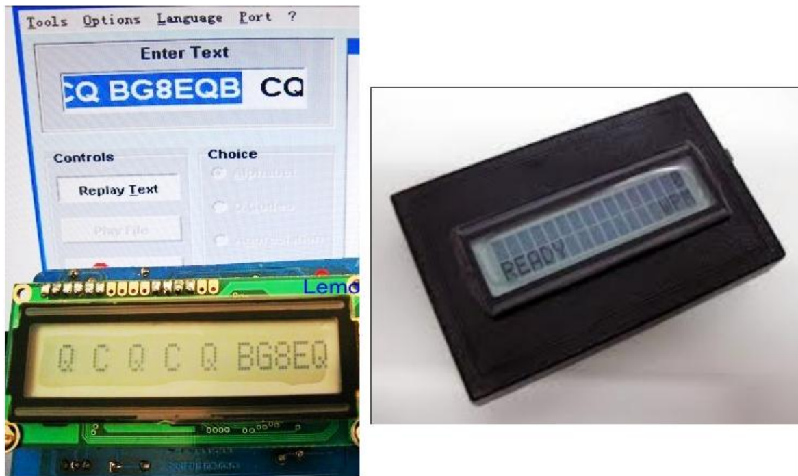
Figura : CW Reader a la izquierda, MFJ461 a la derecha
