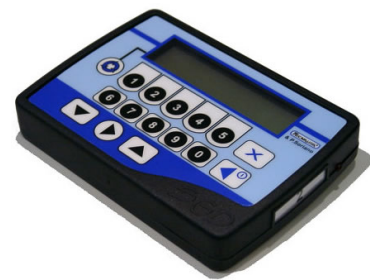
Figura 2.1: El Tamagotxi , un aparell especialment dissenyat per al control d'assistència.
