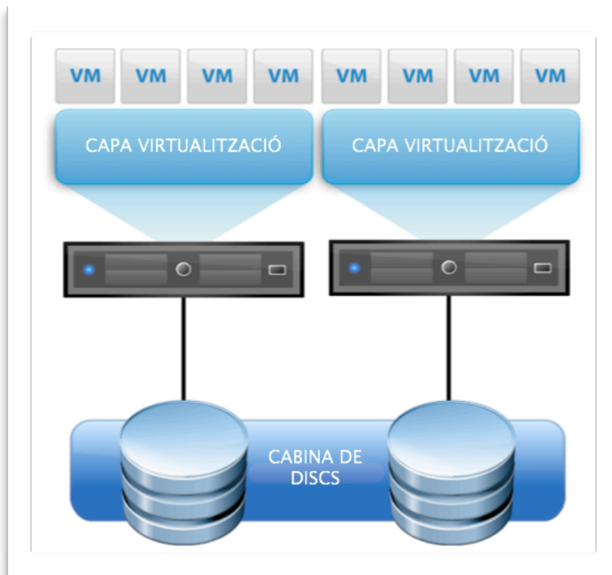
Figura 5.2: Dos servidors físics executant màquines virtuals (VM) i compartint cabina.
