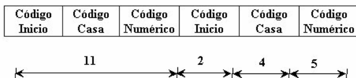
Ilustración 105. Codificación de la trama X-10. Fuente: Domótica Viva. Curso X10 http://www.domoticaviva.com/Tienda/tienda_domotica_x10.php
