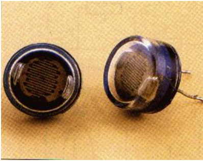
Ilustración 44: Fotorresistencia y aplicación como detector de luz Fuente: Instituto de Educación Secundaria "Bajo Aragón". http://www.iesbajoaragon.com/usuarios/tecnologia/Elec/Elec_1.htm
