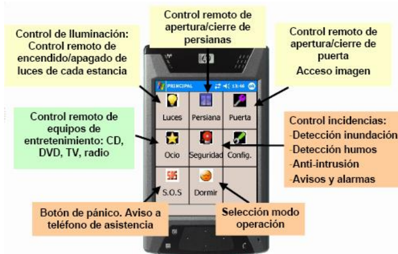
Ilustración 23: Esquema real para gestión y el control desde PDA. Fuente: Hogar Inteligente Accesible, Tendencias y Caso Práctico. http://www.robotiker.com/castellano/noticias/eventos_pdf/45/04%20-%20RBTk%20-%20Hogar%20Inteligente.pdf
