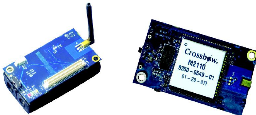
Figura 35. Sistema de mesurament sense fils IRIS.
