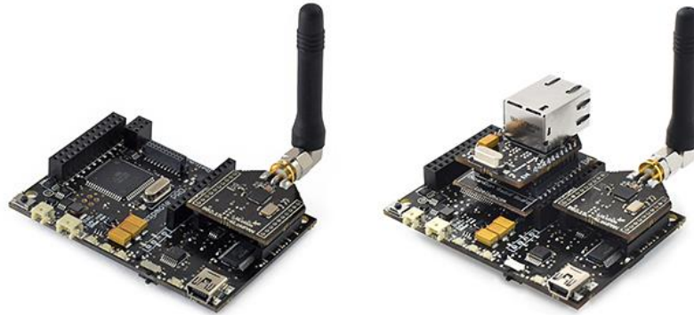
Figura 81. Waspmote amb mòdul ràdio 6LoWPAN a 868 MHz.
