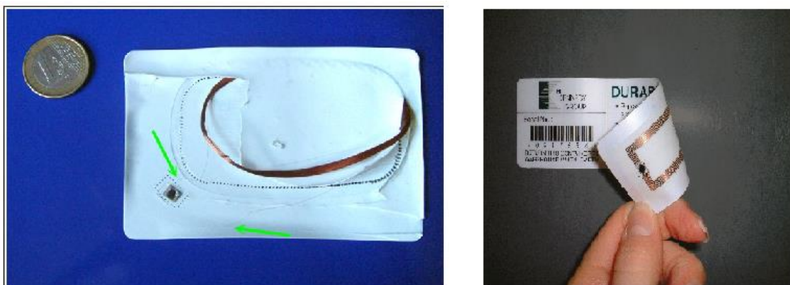
Figura 39. Exemples d'antenes i xips RFID integrats.
