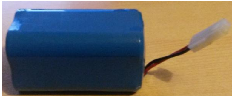
Figura 9. Bateria sistema motor.
