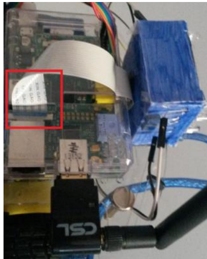
Figura 36. Connexionat càmera en Raspberry Pi.
