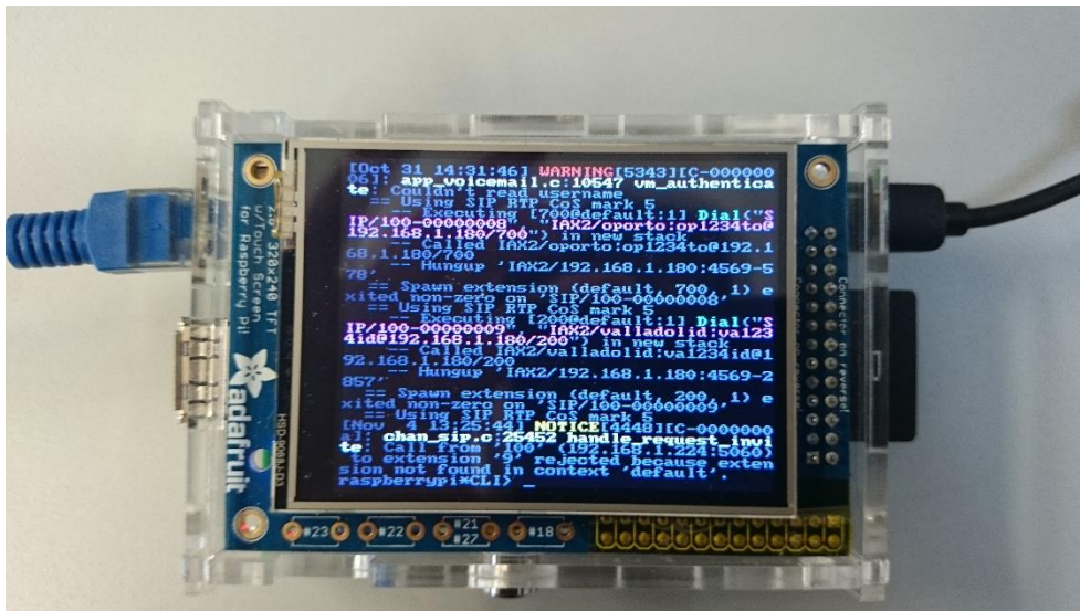
Figura 15. Raspberry Pi funcionando con PITFT ensamblada
