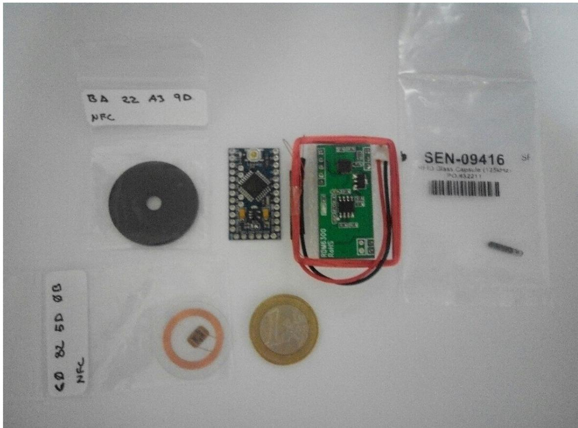
Il·lustració 8 - Arduino Nano, lector RFID y diferentes tipos de etiquetas NFC/RFID
