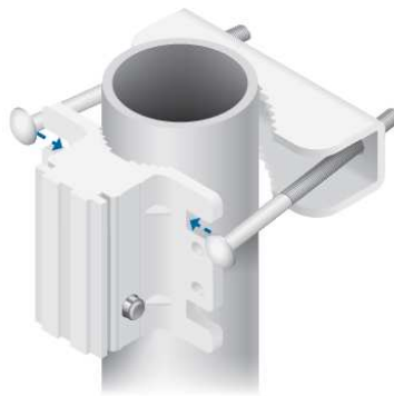
Ilustración 10.17: Instalación del kit del montaje en el poste
