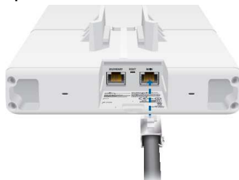
Ilustración 10.20: Conexión del radio a la alimentación eléctrica
