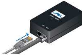
Ilustración 10.8: Conexión de la alimentación eléctrica
