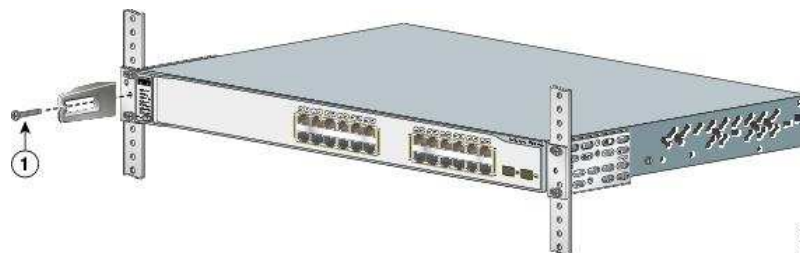
Ilustración 10.12: Instalación de la guía de cables
