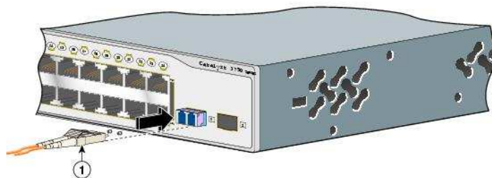
Ilustración 10.15: Conexión de cables de fibra óptica al módulo SFP
