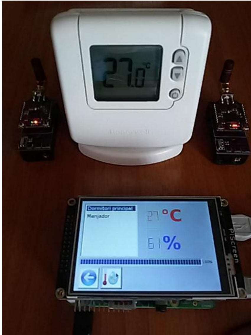
Il·lustració 129: Validar valor de temperatura entre el termòstat i la mota "Dormitori principal"
