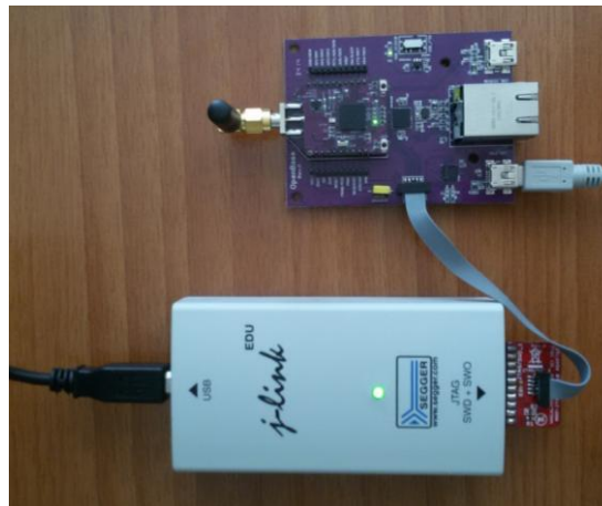
Il·lustració 75: Connexió del JTAG J-Link amb la placa OpenBase
