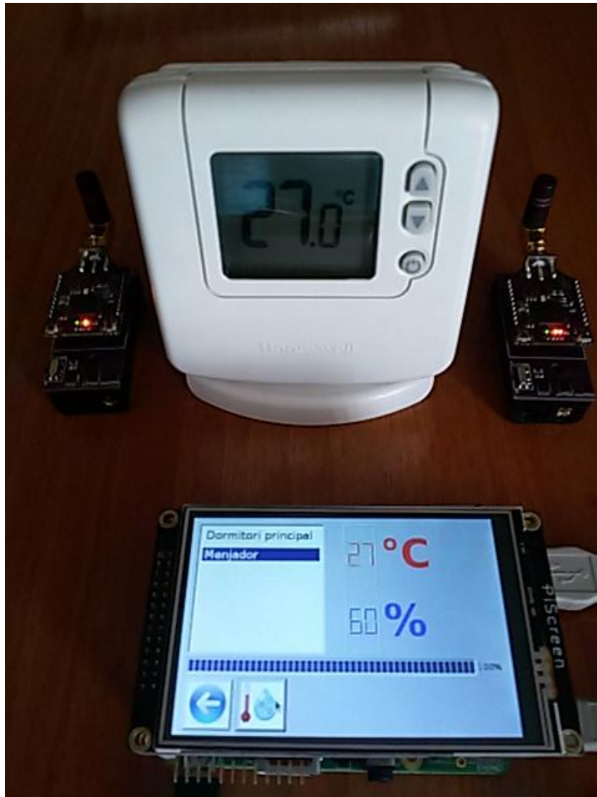
Il·lustració 130: Validar valor de temperatura entre el termòstat i la mota “Menjador”
