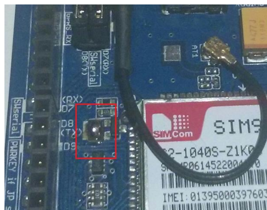
Il·lustració 42: Soldadura de pins encès automàtic mòdul GSM/GPRS
