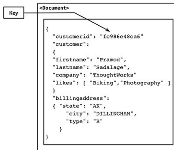
Fig. 2. Exemple d'un document en format JSON d'una base de dades NoSQL.
