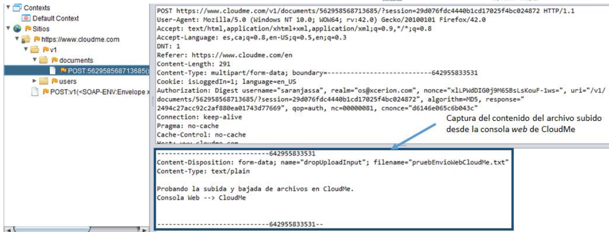
FIGURA 31 – CAPTURA CON ZAP DE LA SUBIDA DE UN ARCHIVO DE TEXTO DESDE LA CONSOLA WEB
