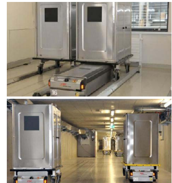
Ejemplo de un sistema de transporte robotizado
