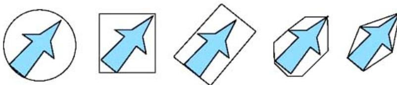
De izquierda a derecha, esfera, caja envolvente alineada con ejes, caja envolvente orientada y k-Dop y envolvente convexa
