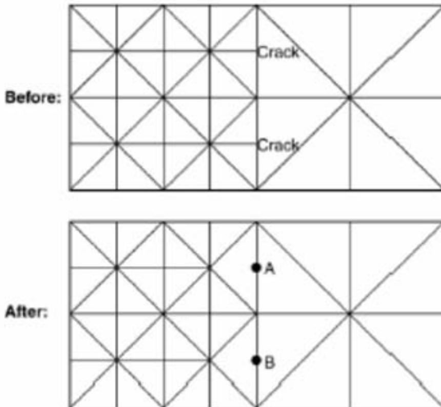
Para evitar la aparición de agujeros (*cracks*), eliminamos los vértices A y B.
