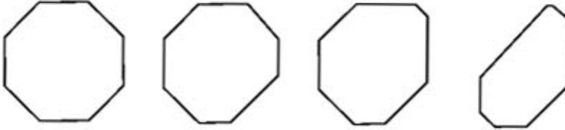
Los distintos *slabs* son ajustados para adaptarse a un objeto, con lo que cambia la forma del volumen envolvente. Los planos que forman un *slab* siempre deben tener el mismo ángulo con la vertical que la configuración original.
