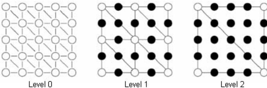
Toma selectiva de vértices del *geomipmapping* según el nivel de detalle.
