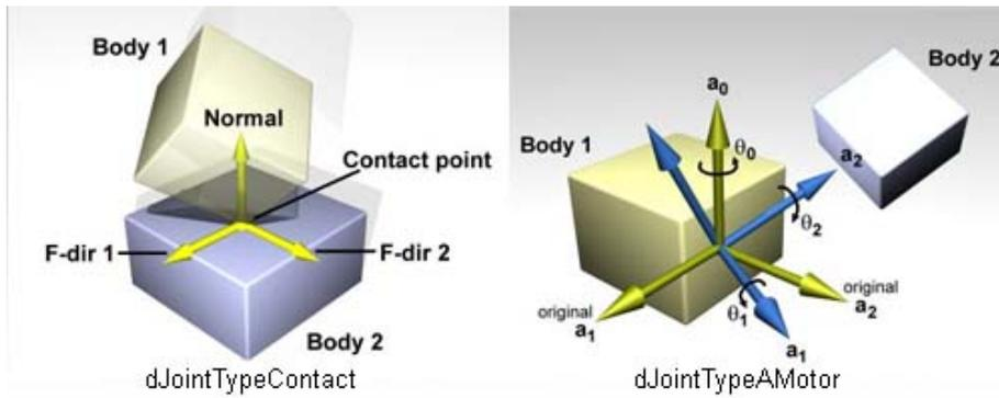
A continuación, describimos las funciones que permiten crear una nueva *join* de un tipo determinado. Inicialmente no tendrá ningún efecto en la simulación; para ello será necesario enlazarla a algún cuerpo. La *join* del contacto será inicializada con la estructura del atributo `dContact`.
