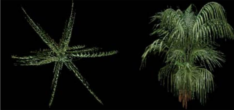
Tres planos correctamente orientados simulando el modelo 3D de un árbol haciendo uso del *alpha test*.
