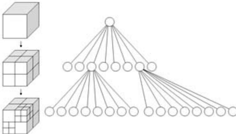
Estructura de un *octree*
