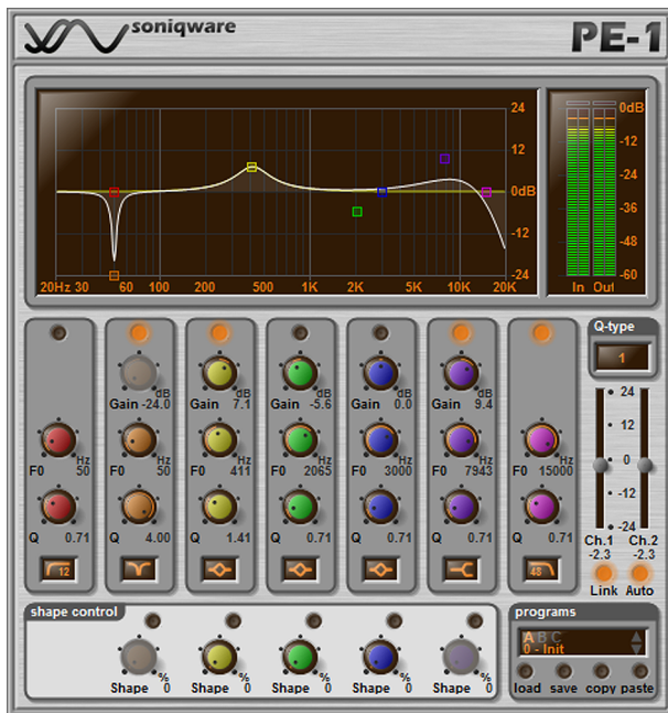
Figura 95. Equalitzador paramètric multibanda que incorpora un filtre passaalt i un de passabaix.
