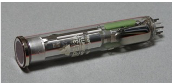
Figura 7. Fotografia d'un sensor de tub d'imatge del tipus vidicó desenvolupat el 1950 per l'RCA
