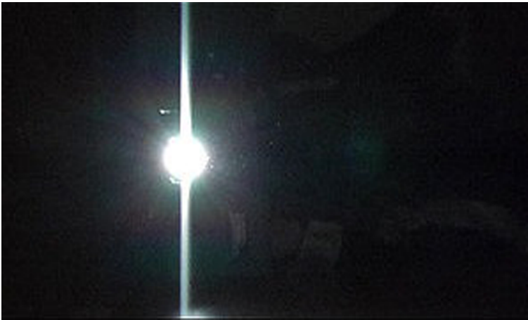
Figura 12. Imatge de l'efecte smear generat per un sensor de CCD
