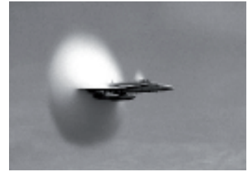
Un F/A-18 Hornet és a punt de trencar la barrera del so sobre les aigües del Pacífic. La "boira" que s'observa darrere l'avió és produïda per la condensació del vapor d'aigua, causada per la caiguda sobtada de pressió que té lloc darrere de l'ona de xoc quan s'està arribant a Mach 1. Aquest fenomen rep el nom de singularitat de Prandtl-Glauert i encara no està descrit perfectament.
