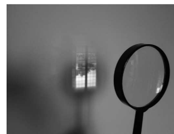
Imatge creada per una lent convergent sobre una paret. Fixeu-vos que la imatge està invertida.
