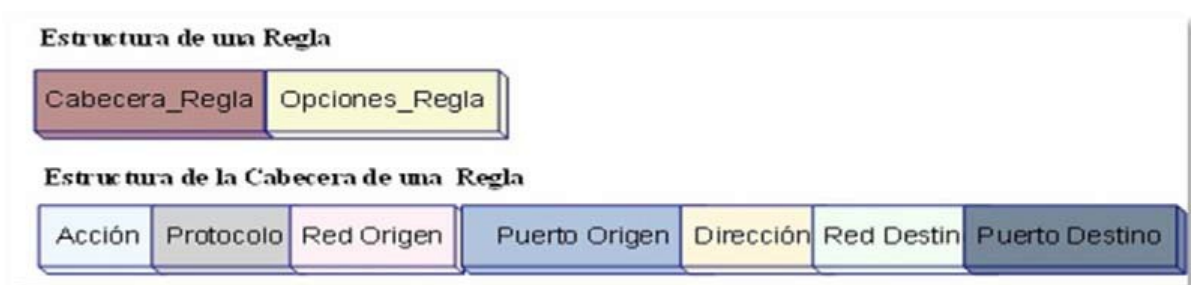
Imatge 5. Estructura d'una regla de Snort i de la seva capçalera
