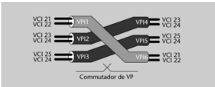
Figura 35. Esquema de commutació de trajectes virtuals
