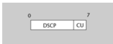
Figura 10. Format del camp DS utilitzat per a definir el comportament per salt en els encaminadors intermedis
