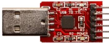
Figura 2: Detalle del conversor CP2102
