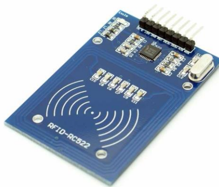
Il·lustració 7. Sensor RFID
