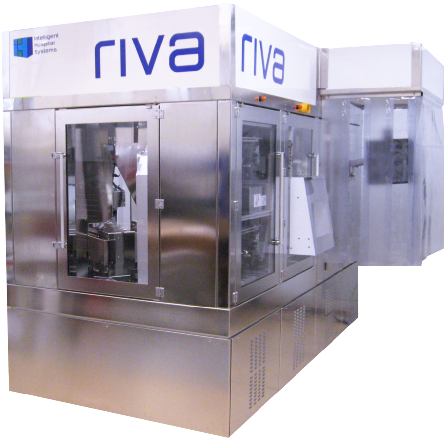
Robot RIVA (Robotic IV Automation) para el llenado estéril de jeringas y bolsas para la administración IV
