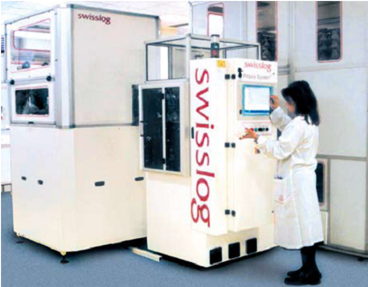
Robot PillPick® de Swisslog que permite simultáneamente el reenvasado en dosis unitarias y el llenado de los carros
