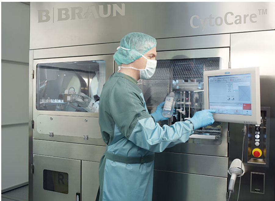
Robot CytoCare® (Devon Robotics) para la manipulación de citostáticos
