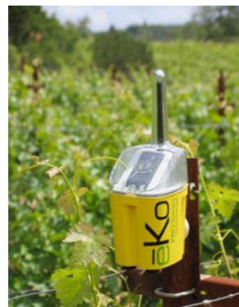
Control de les vinyes fent ús d'un dispositiu encastat dotat d'interfície de comunicació sense fil
