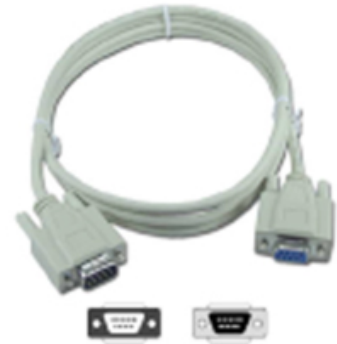
Port sèrie basat en RS-232 amb connector de 9 pins DB-9
