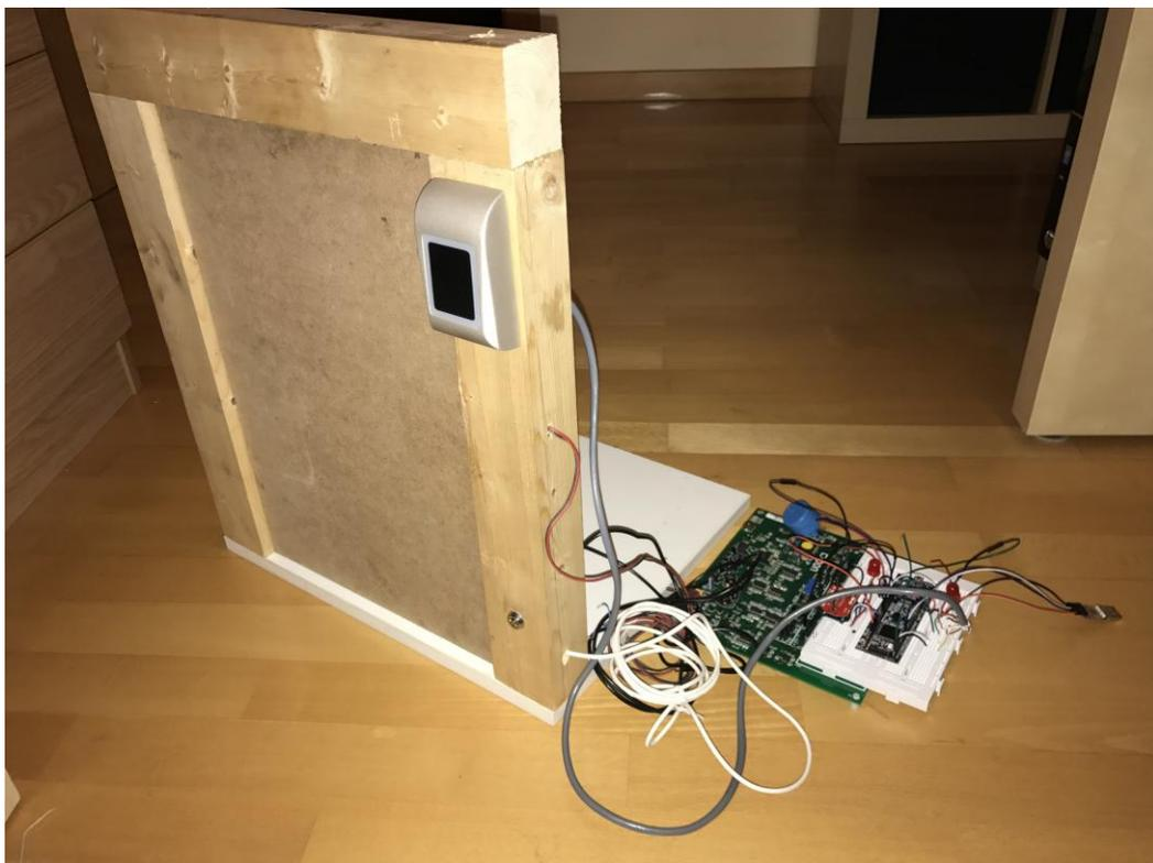
Figura 18: Prototipo de sistema de intrusión y control de accesos
