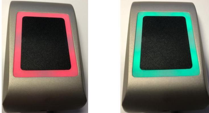
Figura 29: Led de estado armado y desarmado
