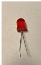
Figura 11: Diodo LED
