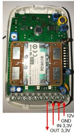
Figura 35: Conexión Detector volumétrico
