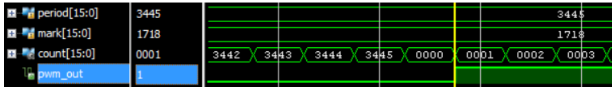
Figura 21. Anàlisi temporal de set del comptador del PWM2
