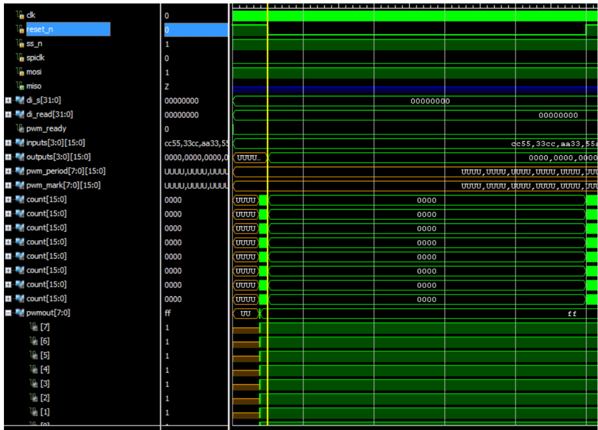
Figura 16. Anàlisi temporal del senyal de reset
