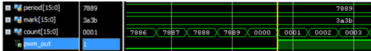
Figura 25. Anàlisi temporal de set del comptador del PWM4
