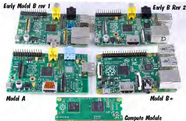
Figura 11: Tipos de PCB basados en microcontrolador Raspberry Pi
