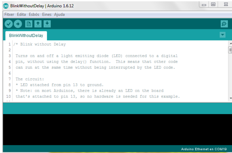
Figura 12 Captura de pantalla de IDE oficial d'Arduino amb el codi d'exemple Blink
