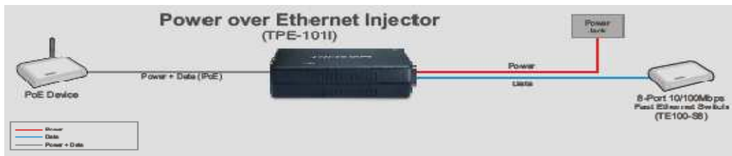
Figura 33: Imagen de la conexión del inyector PoE.
