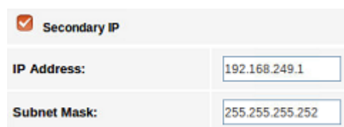
IL·LUSTRACIÓ 10 - HABILITACIÓ SEGONA INTERFÍCIE DE XARXA AL ROUTER
