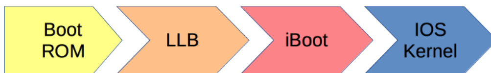
Proceso de inicialización del firmware Secure Boot Chain
