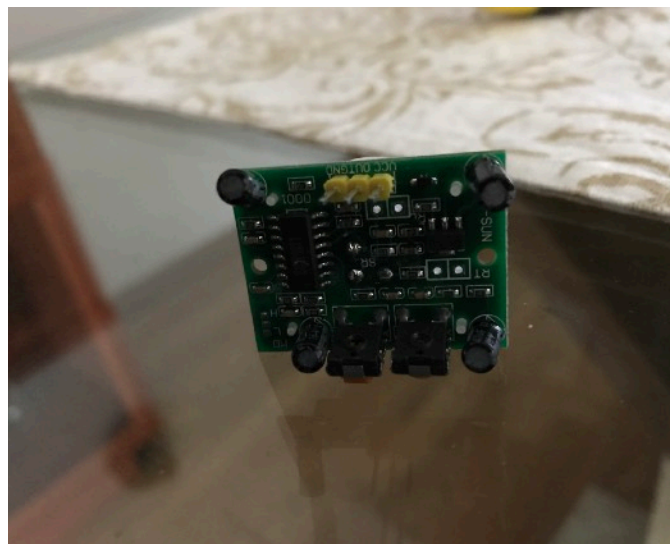
Figura 23. Fotografia d'un sensor PIR HC-SR501. Part darrera
