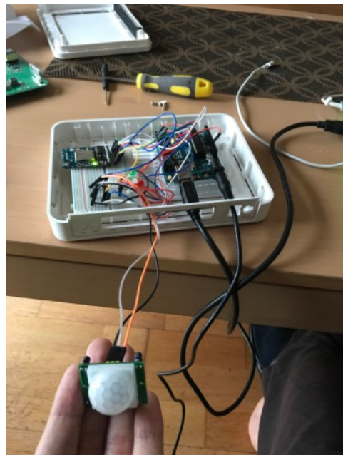
Figura 41. a ) Mòdem Vodafone amb els components del sistema del projecte introduïts. b) Mòdem Vodafone amb els components del sistema del projecte introduïts mostrant el sensor PIR.
