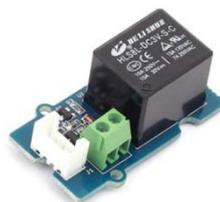
Ilustración 27. Módulo relé 220 VAC 10A.
