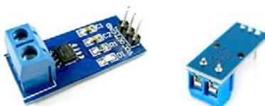
Ilustración 6. Sensor de corriente ACS712.
