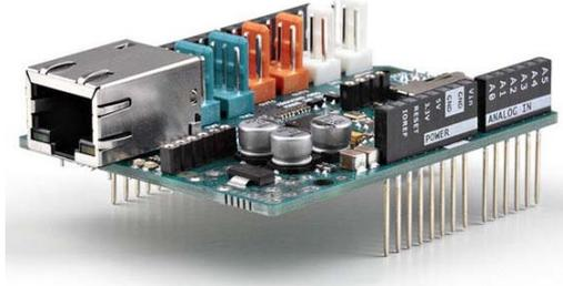
Ilustración 12. Ethernet Shield V2.
