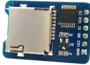
Ilustración 40. Lector micro-SD Arduino
