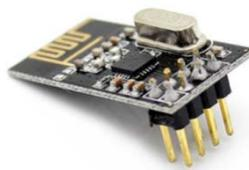
Ilustración 16. Placa NRF24L01.
