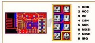
Ilustración 18. Pines SPI en módulo NRF24L01.
