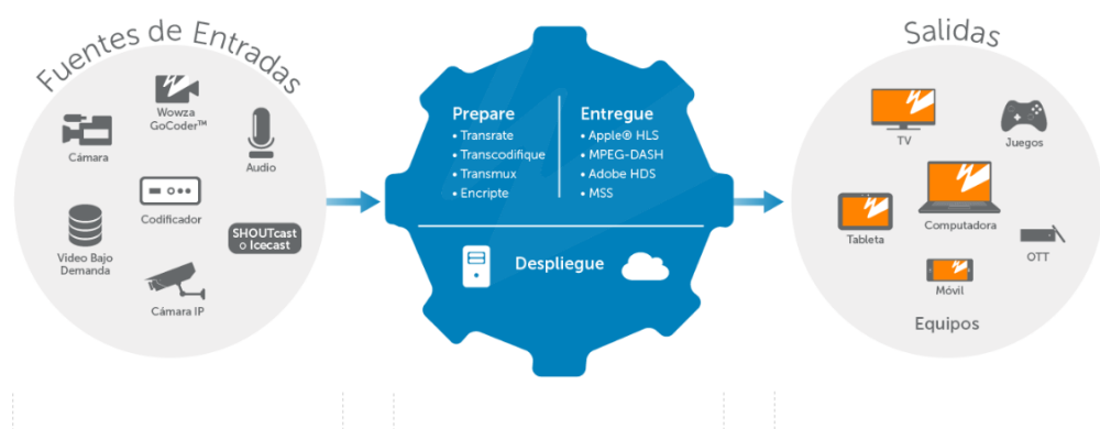
Ilustración 28. Arquitectura Wowza Streaming Engine.
