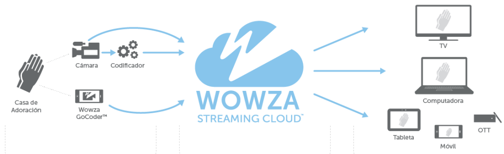
Ilustración 27. Arquitectura Wowza Streaming Cloud.
