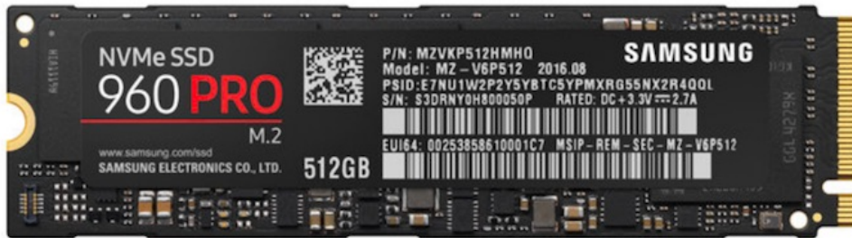
Figuras 3 y 4. Arriba memoria SSD tipo M.2 y abajo disco SSHD (híbrido)
