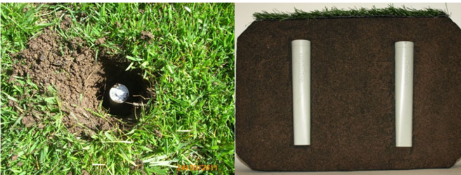
Figura 56. La primera foto corresponde a un sensor de humedad enterrado en una zona ajardinada y la segunda, a una vista de perfil del mismo sensor.
