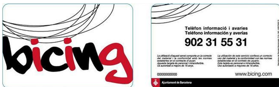
Figura 25. Tarjetas RFID del sistema de bicicletas compartidas de Barcelona.
