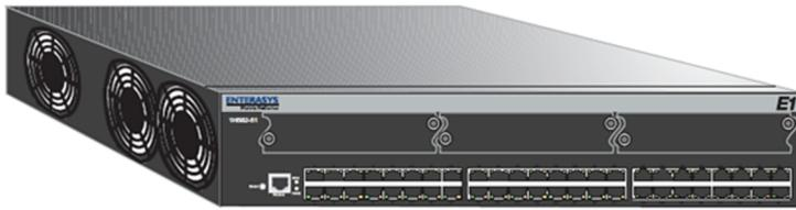
En la parte inferior pueden verse las 48 bocas fe de cobre y en la superior, los tres *slots* de expansión (vacíos en esta ilustración)
