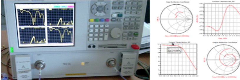
Figura 8. Analizador de redes: medida de parámetros S
